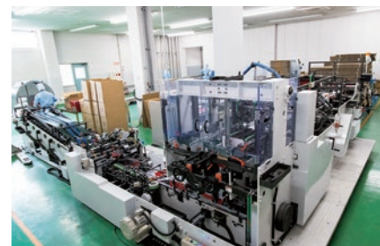
耐油剤を内面塗布した箱を貼り合わせる8点貼り機
