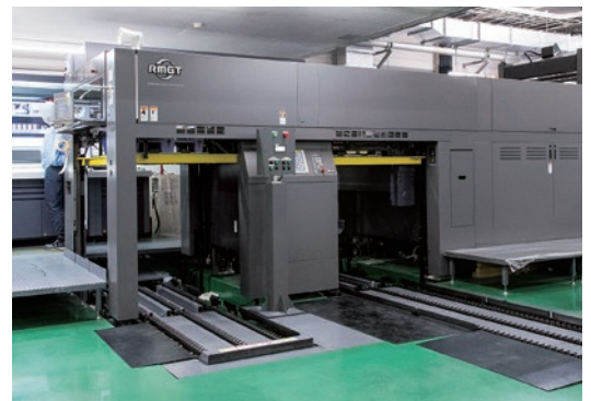
2連デリバリー装置。右側の正紙用デリバリーはデリバリーシャッターを備え、ノンストップロングラン運転に貢献
